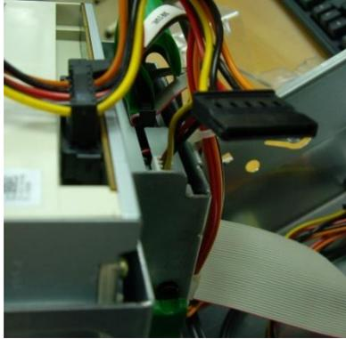
**S-ATA插頭**：它使用差動信號系統，能有效的將雜訊從正常訊號中濾除，良好的雜訊濾除能力使得S-ATA只要使用低電壓操作即可。
