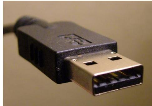
USB 採用獨特的連接器和接頭。USB A 連接器直接連到電腦或 USB 集線器上。USB B 會在具有可拆卸的電纜的設備上找到。
